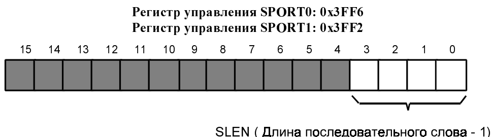
Рис. 5.4 Группа разрядов SLEN в регистре управления последовательным портом
