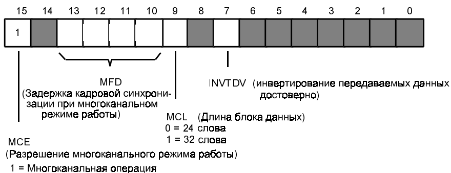
Рис. 5.23 Регистр управления SPORT0 при разрешенном многоканальном режиме работы
