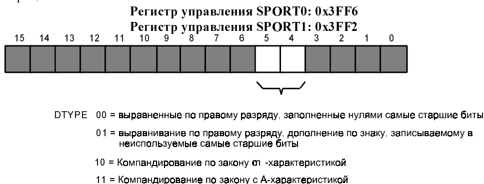
Рис. 5.21 Группа разрядов DTYPE в регистре управления последовательным портом
