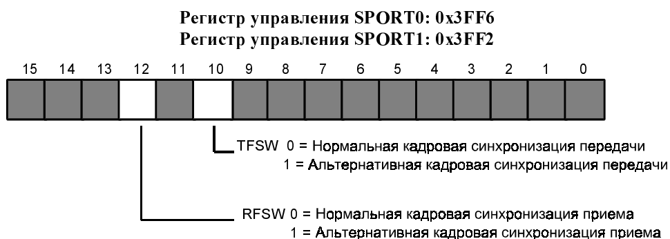
Рис. 5.7 Биты TFSW и RFSW регистра управления последовательным портом
