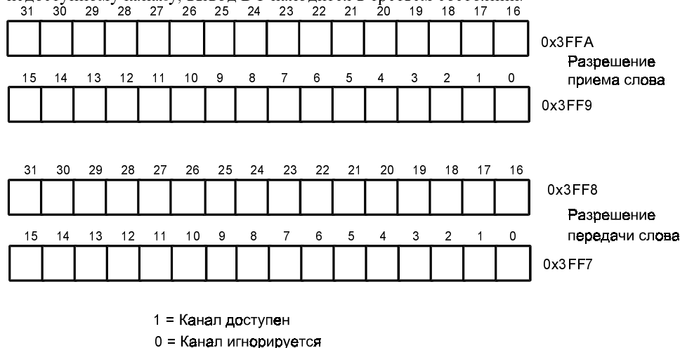
Рис. 5.25 Регистры разрешения многоканального приема/передачи слов данных
