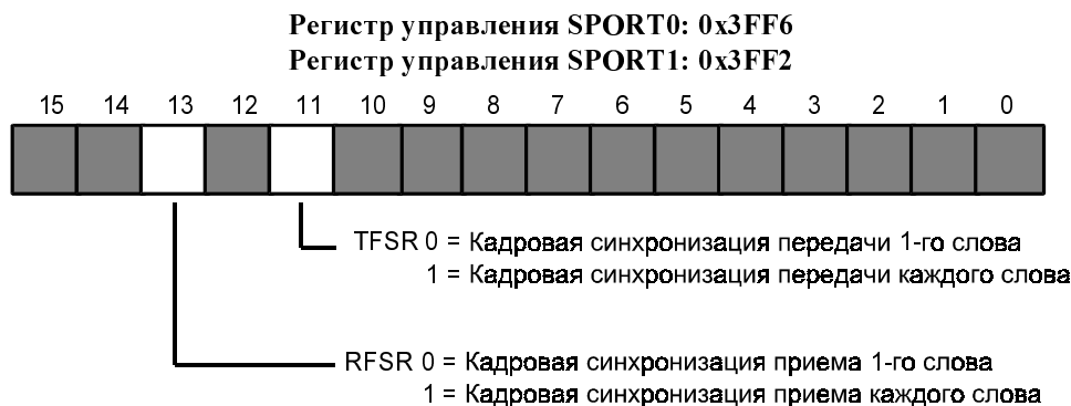
Рис. 5.5 Биты TFSR и RFSR в регистре управления последовательным портом
