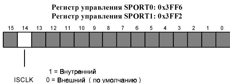
Рис. 5.3 Бит ISCLK регистра управления последовательным портом
